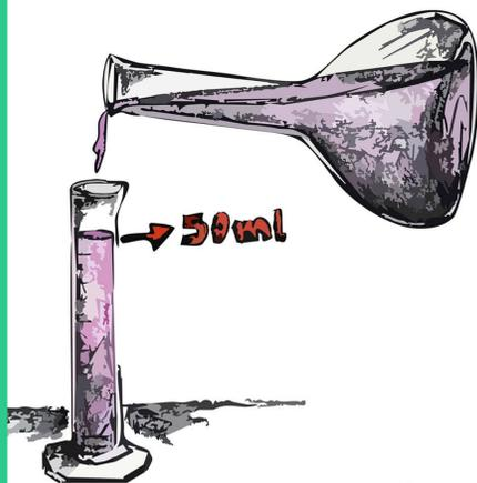
Após o término da titulação o volume de NaOH consumido deverá ser anotado e empregado como referência para calcular a quantidade de ácido acético presente no vinagre artesanal, conforme a Equação 1.
